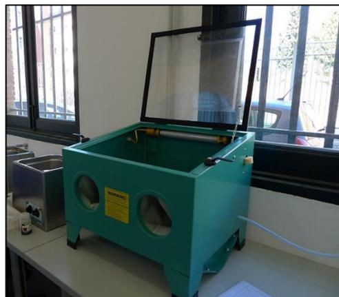
Nos permite simular erosión por las arenas de desierto o por aire a presión.
