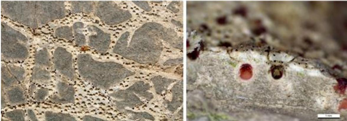
Imágenes mostrando las microperforaciones generadas en la caliza de Persépolis por la colonización *Bagglietia* sp. Derecha vista superficial de la caliza colonizada. Izquierda, caliza cortada transversalmente mostrando el desarrollo de cuerpos fructíferos de esta especie y la formación de microperforaciones al emerger a la superficie. Imágenes obtenidas por Sergio Pérez Ortega (RJB-CSIC)
